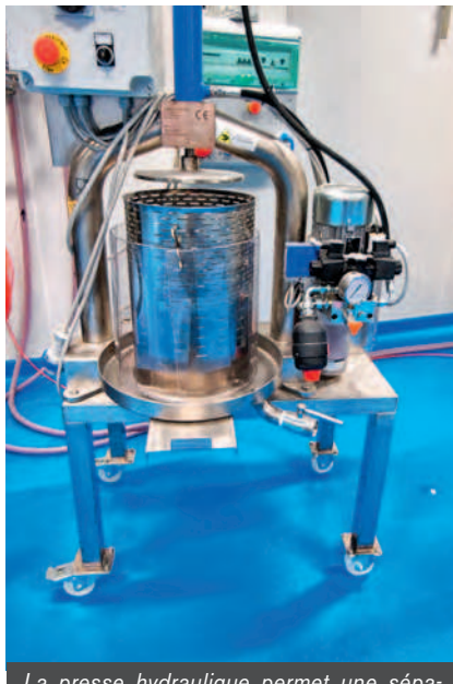
La presse hydraulique permet une séparation solide/liquide ou une extraction par pression mécanique à froid (capacité de 1 à 5 litres de matières premières).
