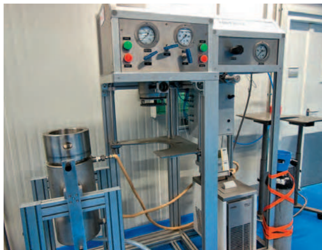
Le Zippertex est un pilote d'extraction à eau subcritique (eau soumise à haute pression et haute température) de 10 litres de capacité.
