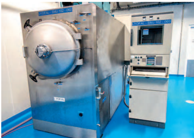
Le lyophilisateur est utilisé avant ou après extraction. Il permet un séchage par lyophilisation (batch de 30 kg).
