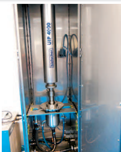
Extracteur à intensification par ultrasons en continu ou en batch (ici le modèle Ultrason UIP 4000 Hielscher), d'une capacité moyenne de 1 m 3 /h en fonction de l'application.
