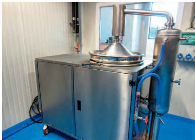
L'hydrodistillateur Drago, une méthode classique pour produire des huiles essentielles à partir de plantes (entraînement à la vapeur, capacité de 250 litres de matières premières).
