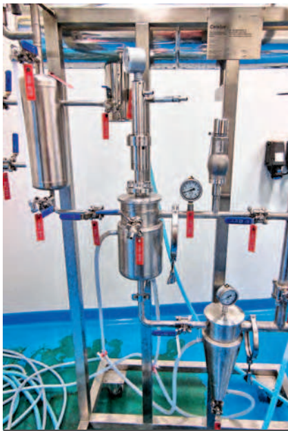
Le Nectacel 1 est un pilote d'extraction à gaz liquéfié (butane, DME, gaz fluorés, etc.), avec une capacité de 1 litre.
